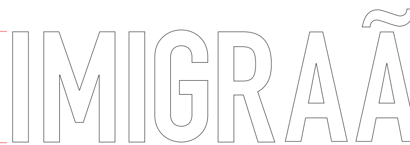
LETRA CAIXA EM CHAPA GALVANIZADA PINTURA PANTONE 7581C / ESPESSURA 70CM
